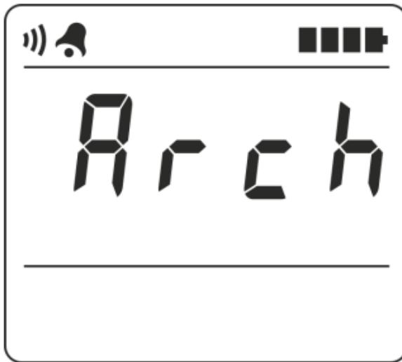
Рисунок 5 – РКІ радіометра (початок підрежimu збереження результату вимірювання в енергонезалежній пам'яті)
