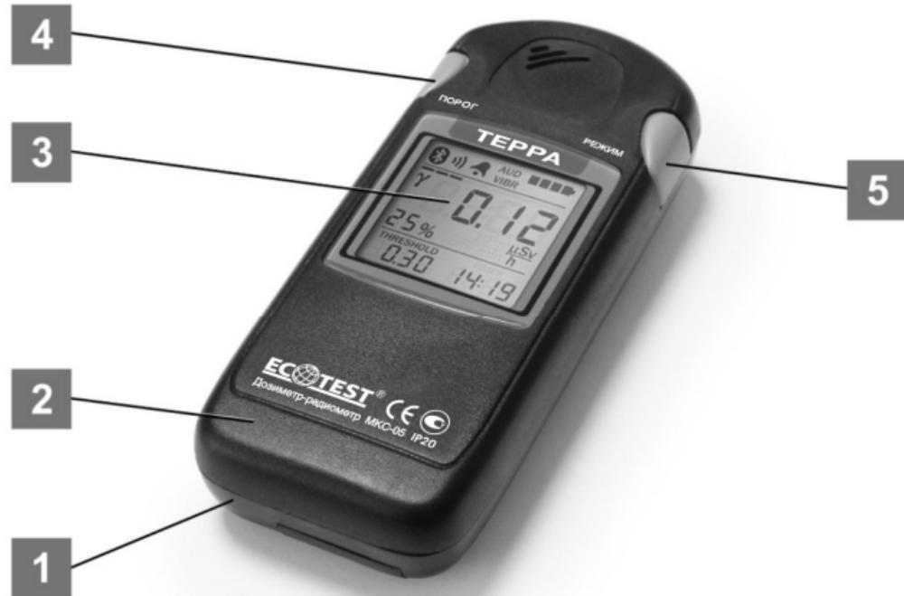
Рисунок 1 - Внешний вид дозиметра (вид сверху)
