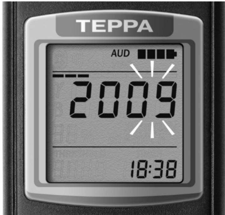
Рисунок 23 – ЖКИ дозиметра
