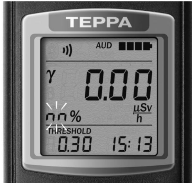
Рисунок 6 – ЖКИ дозиметра (перезапуск измерения)
