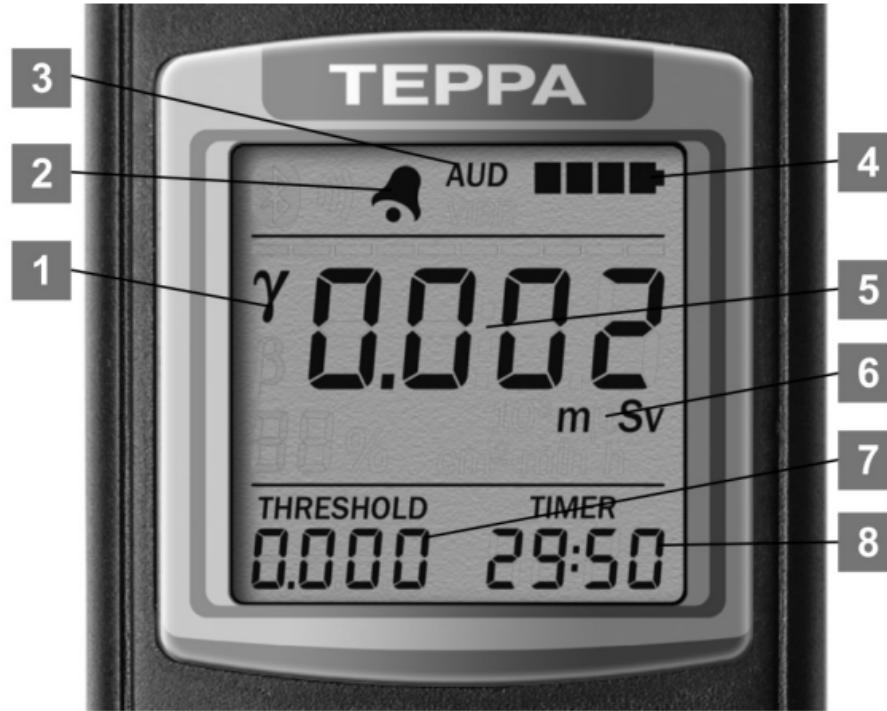
Рисунок 11 – ЖКИ дозиметра
