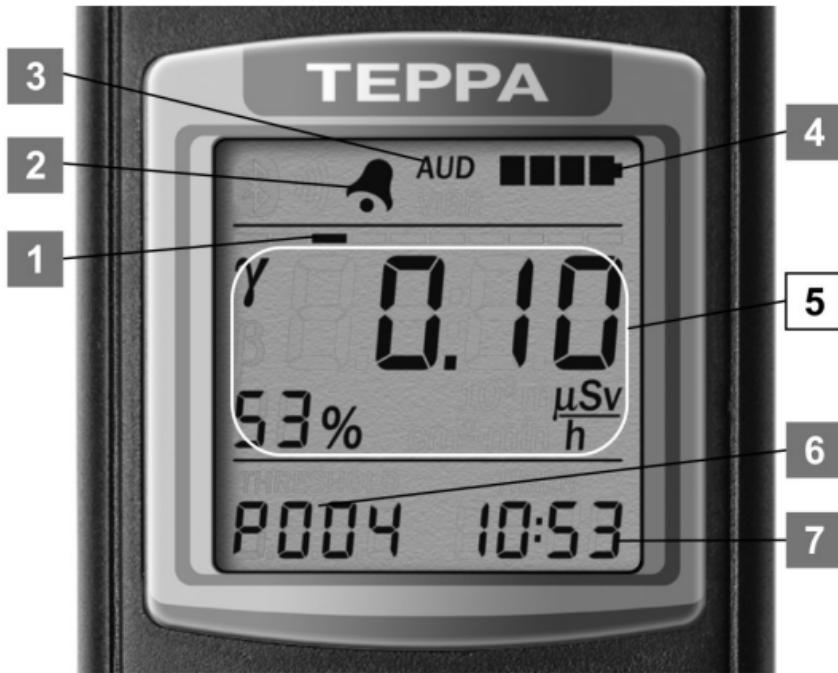
Рисунок 30 – ЖКИ дозиметра
