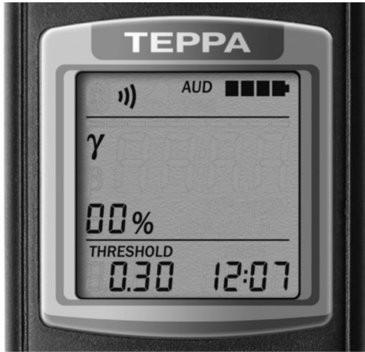
Рисунок 4 – ЖКИ дозиметра
