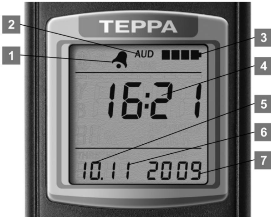
Рисунок 21 – ЖКИ дозиметра
