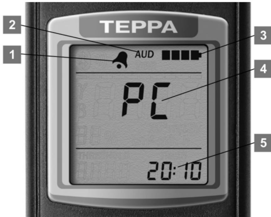
Рисунок 27 – ЖКИ дозиметра
