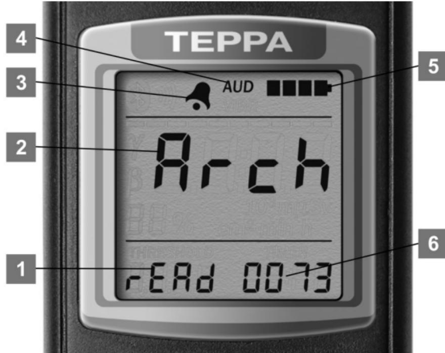
Рисунок 29 – ЖКИ дозиметра
