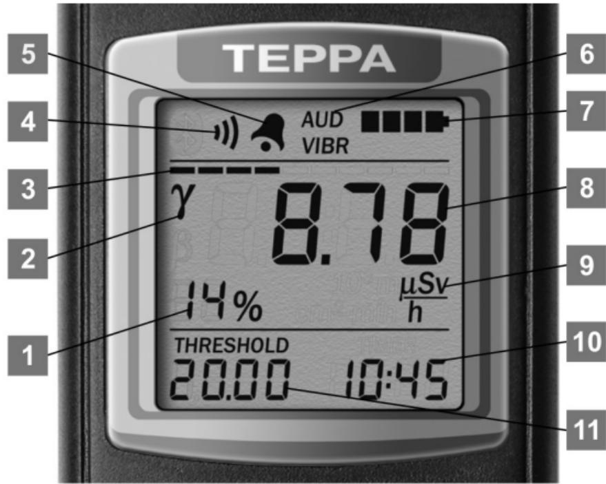
Рисунок 3 – ЖКИ дозиметра
