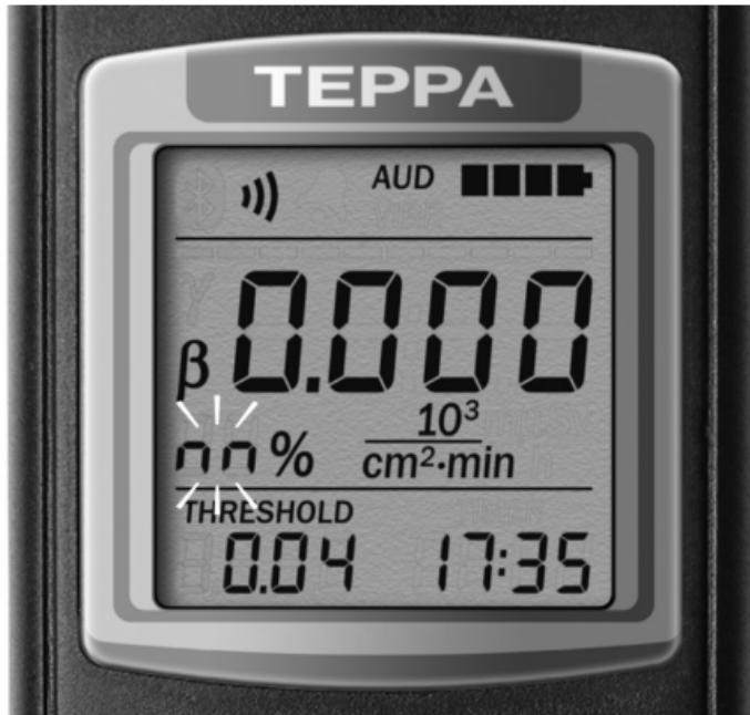
Рисунок 17 – ЖКИ дозиметра (перезапуск измерения)
