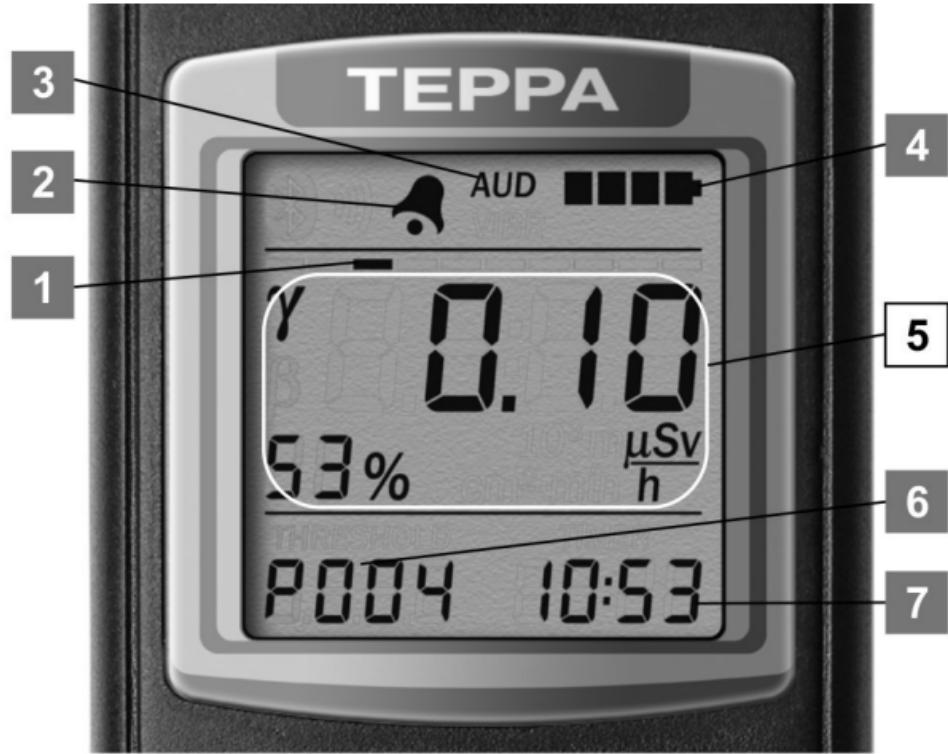
Рисунок 30 – PKI дозиметра
