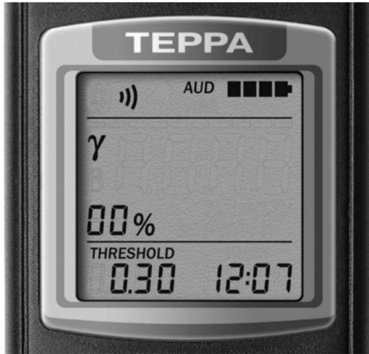
Рисунок 4 – PKI дозиметра
