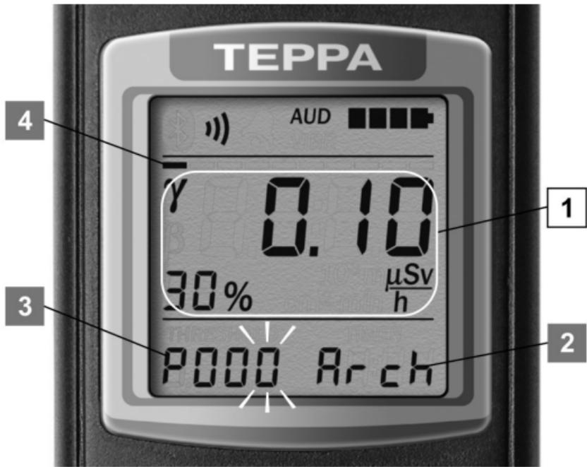
Рисунок 10 – РКІ дозиметра
