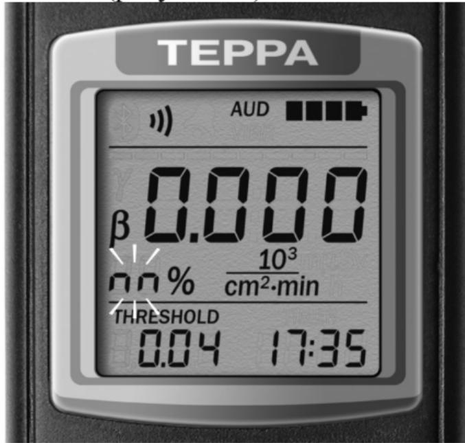
Рисунок 17 – PKI дозиметра (перезапуск вимірювання)
