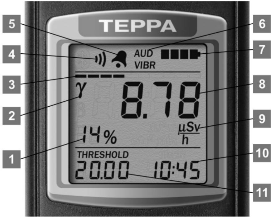
Рисунок 3 – РКІ дозиметра
