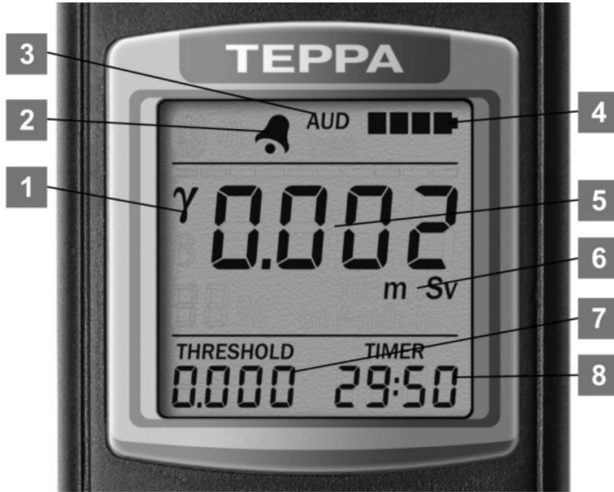
Рисунок 11 – РКІ дозиметра
