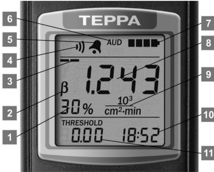
Рисунок 14 – РКІ дозиметра
