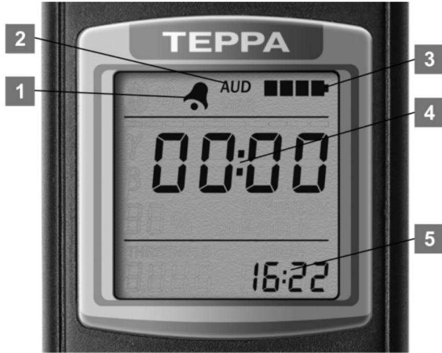
Рисунок 25 – PKI дозиметра
